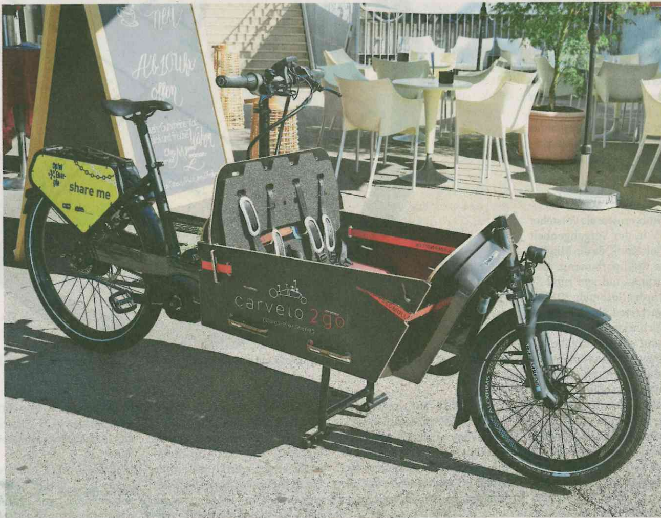
Das Cargo-Bike ist ein spezielles Velo: Zwischen Lenkrad und Vorderrad befindet sich ein Laderaum.
